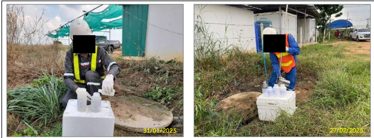
รูปที่ 3-6 ตัวอย่างการติดตามตรวจสอบคุณภาพน้ำทิ้งจากสำนักงานชั่วคราว พื้นที่เก็บท่อ และวัสดุ/อุปกรณ์ของโครงการ
