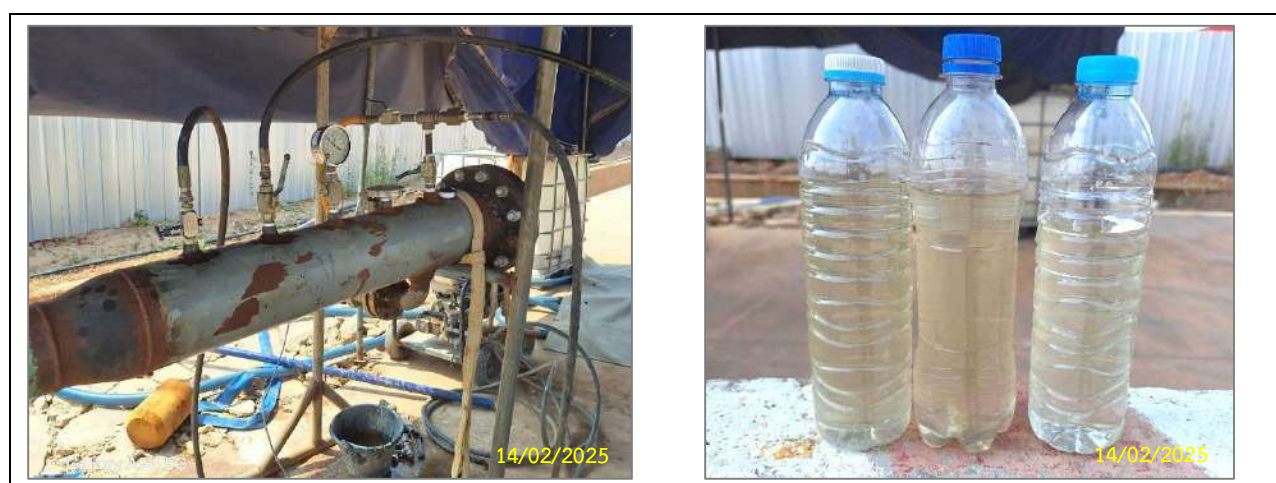
รูปที่ 3-5 การติดตามตรวจสอบคุณภาพน้ำทั้งจากกิจกรรมการทดสอบท่อด้วยวิธีทางชลสถิต
